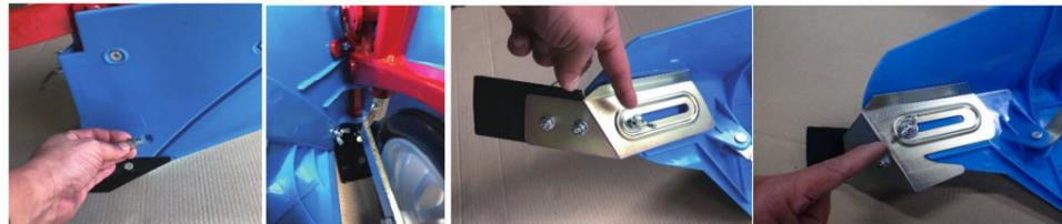
本体部分と羽根を合わせ、2か所の六角溝に六角ボルトを差込み、下から取付けます。
