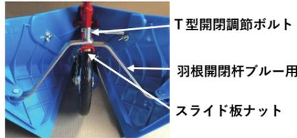
T型開閉調節ボルトと、板ナットを一度取り外し、羽根開閉杆の左右を上下に合わせて、再度締め付けて下さい。
