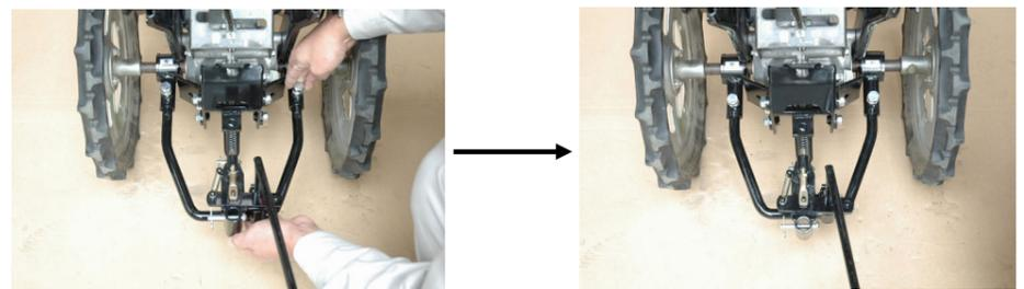
(6) 最後にヒッチ台座についての押しバネ部分をコ型ヒッチにピンとRピンで止めて下さい。
