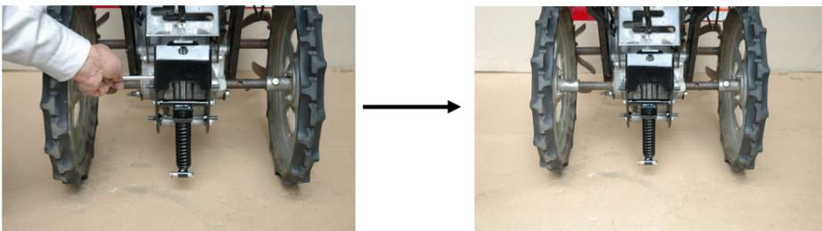
(3) 本機のタイヤを片側ずつ取りはずし、回転軸の左・右を車軸にはめ込みヒッチ台座に固定して下さい。
