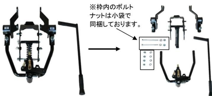
(2) 本機のミッションケースにヒッチ台座を2本のボルトでしっかり固定して下さい。
