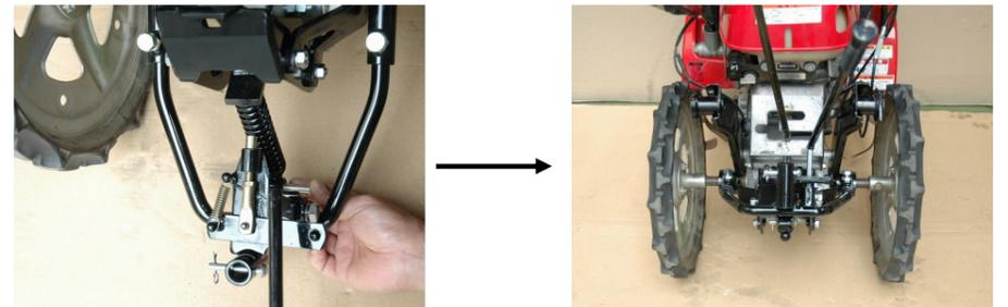
《備考》 ヒッチピンが穴にかかりが浅い場合や深すぎる場合はヒッチピンのナットを緩め、ピンを回して微調整して下さい。
