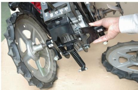
(5) コ型ヒッチの先端を左・右の回転軸の差込み口にあてがい、奥までしっかり差し込みボルトで固定して下さい。
