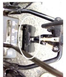
(3) 本機のタイヤを片側づつ取りはずし回転軸の左・右を車軸にはめ込みヒッチ台座に固定して下さい。
