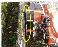
◀ディスク板の採用でコンクリート際の作業も安定します。
