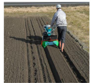
タイヤが前にある管理機(TRS60・70)の場合は(写真④)の様に、あらかじめ畝を立てたい場所に管理機のロータリを止めてロータリを上へ上げてタイヤ跡を(写真⑤)の様にそのタイヤ跡にもう一度管理機のタイヤをはめ込んでロータリを付け、正転で回転させて畝を立てる様にするとまっすぐきれいな畝立てができます。
