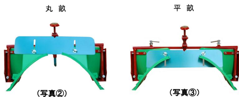
1. 丸畝作りの際は、(写真②)の様にプレートを上方向にスライドさせて、畝の天場が丸畝になる様にして作業して下さい。
